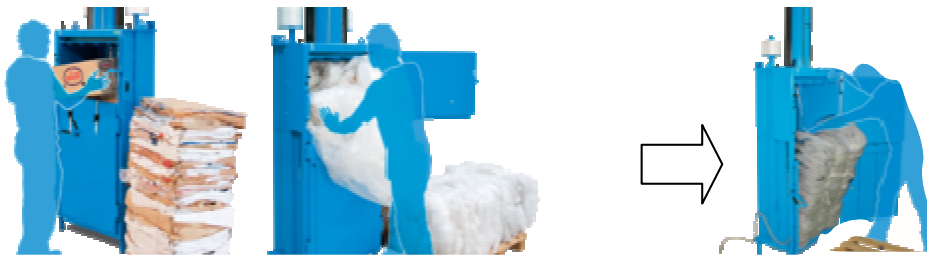
Proceso de compactación
