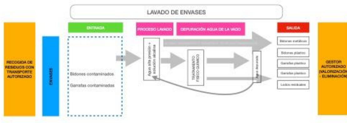
Ilustración 5. esquema funcional, lavado de envases.
